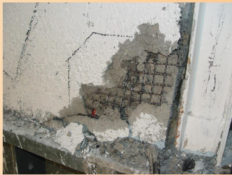
موقعیت اتصال 3 در پایان آزمایش
