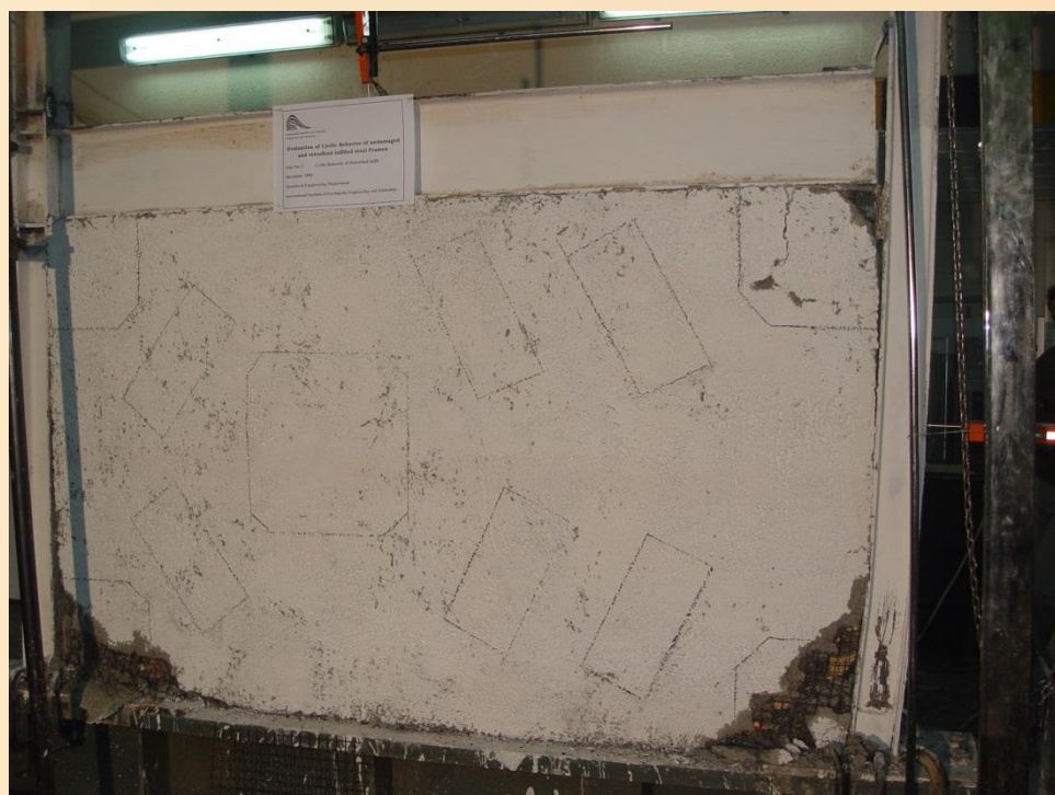
موقعیت ترکها وشبکه های سیمی در پایان آزمایش
