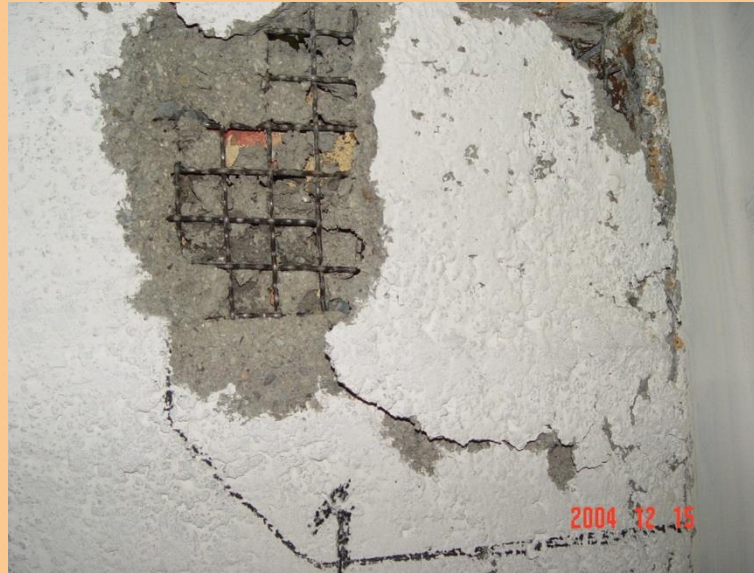
موقعیت اتصال 1 در پایان آزمایش
